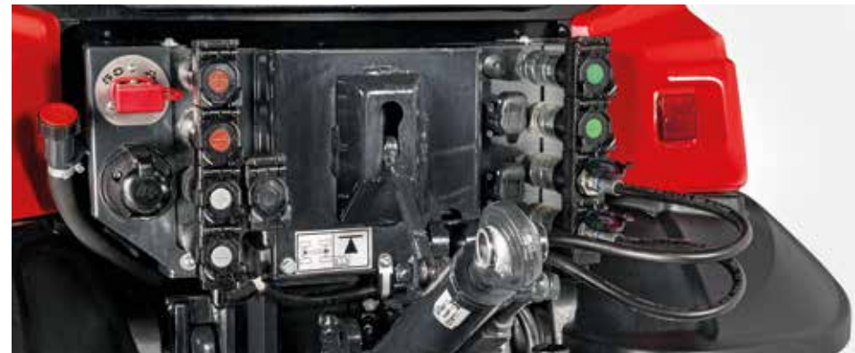
SYSTÈME HYDRAULIQUE ARRIÈRE
