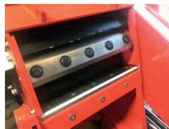
Détail du rotor avec couteaux et contre-couteaux
