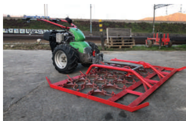
Accessoire trainé Grâce à la conception structurelle de la herse de prairie, il est facile de travailler en marche avant.
