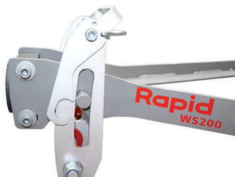
En position de travail, herse de prairie en position flottante
