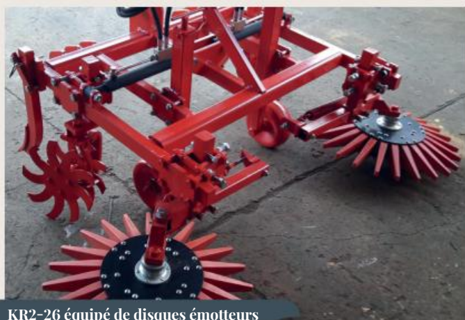
KR2-26 équipé de disques émotteurs
