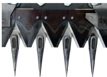
Barre de coupe rubis Écartement des doigts 58 mm
