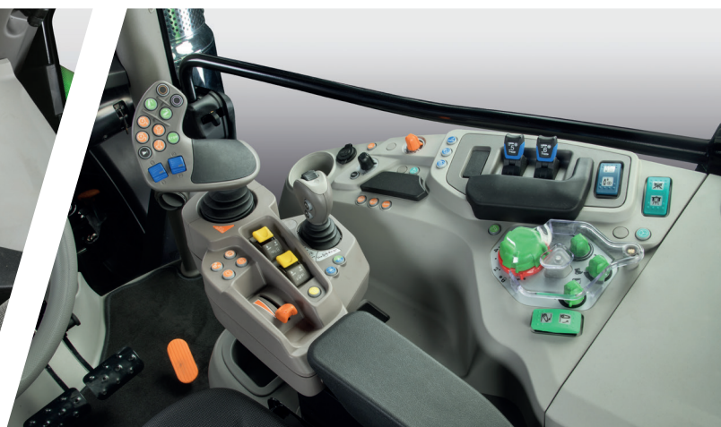
> Configuration du distributeur entièrement électrique associée à la transmission TTV.
