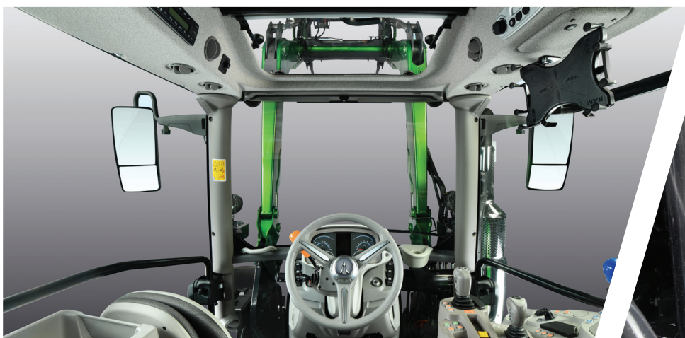
> Trappe de toit et colonne de direction réglable.
