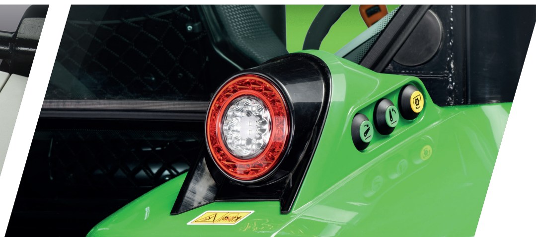
> Commandes extérieures de la PDF et du relevage arrière.
