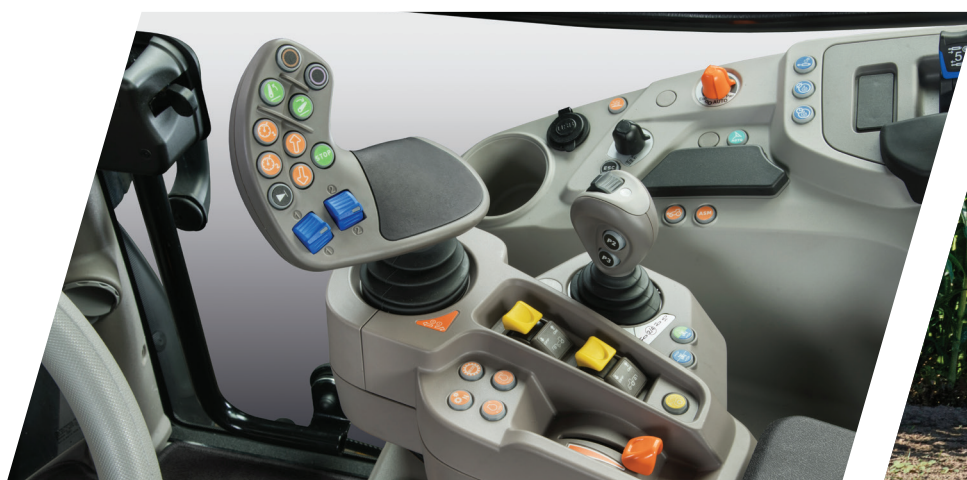
> Accoudoir ergonomique avec joystick MaxCom
