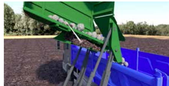
4. Le bac récupérateur de terre se trouvant derrière la grille de la paroi arrière permet de séparer la terre pendant la phase de déversement.
