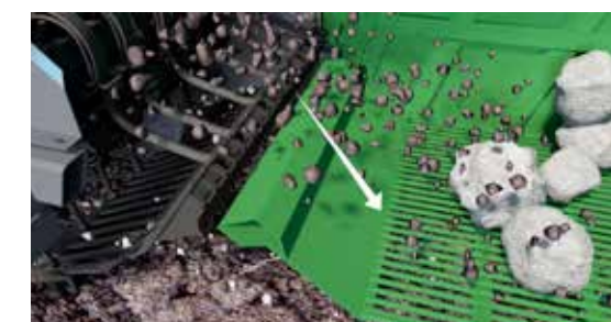
3. Lorsque la pierre atterrit dans la trémie, la terre re-tombe dans le champ par la grille du dessous.
