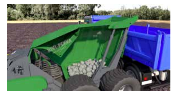
1. La ramasseuse Kivi-Pekka retire la terre en trois étapes
