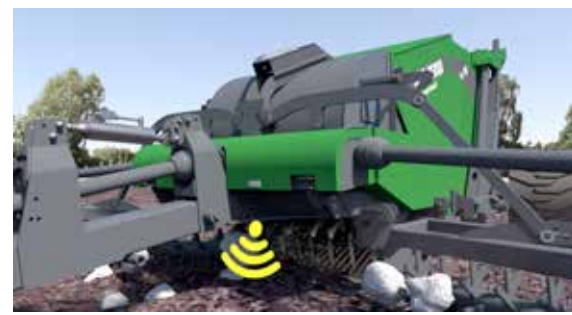
2. La pierre passe sur la grille qui se trouve sous le rotor de chargement.
