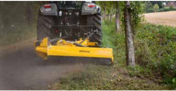
Une grande zone de portée permet de travailler tant à l'arrière que sur le côté du tracteur. Permet d'intervenir sur les voies d'accès étroites comme sur les accotements.
