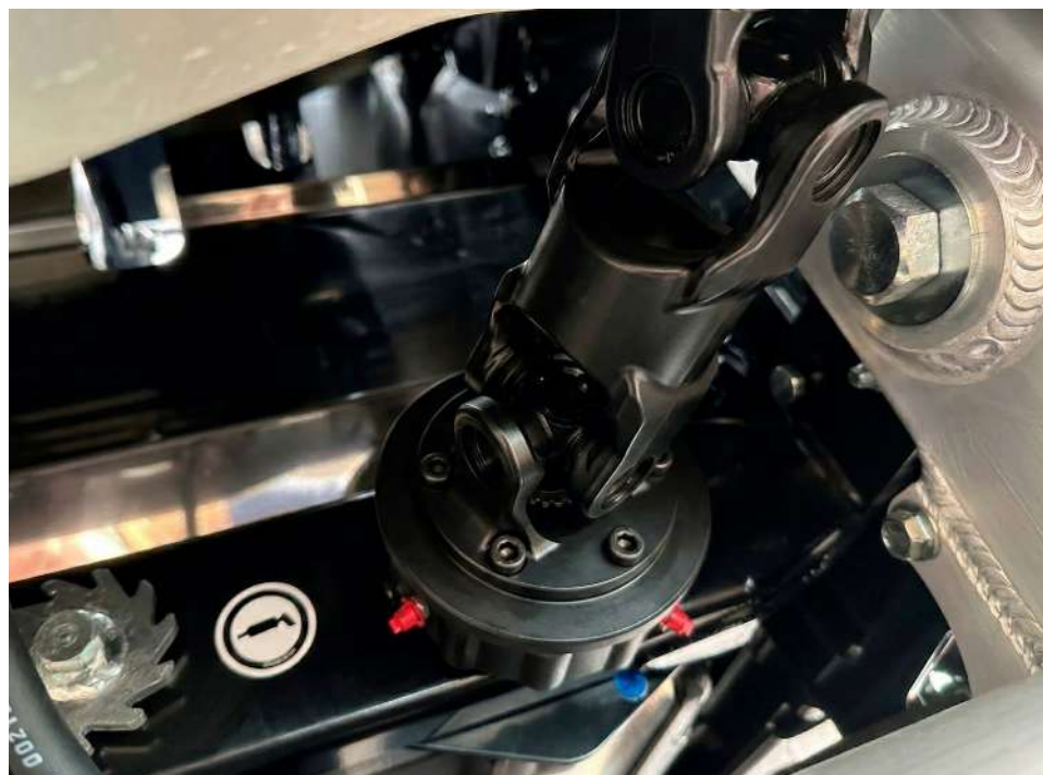
Entraînement mécanique tapis latéraux.
