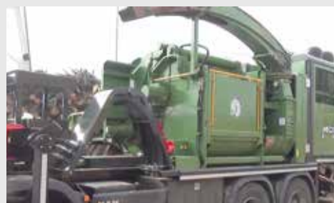
Entraînement de la grue par le moteur de la machine
