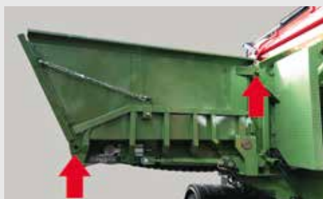
Crochets à fixation rapide sur les côtés du réservoir
