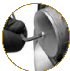
Dévisser à l'aide d'une clé 6 pans le capot de protection du filtre à air
