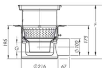
Pour Rhône® 100B/100 et 170 latéral modèle 25100IPL. Assemblage par joint EPDM.
