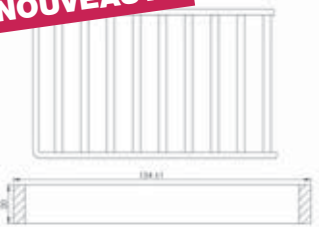
Réf. CR200-H-C250 Barreaux hygiène (soudures continues) largeur 8 mm, fente 19 mm. Egalement disponible en CR300-H-C250. Hauteur 25 mm
