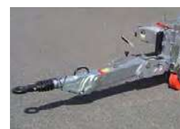
Timon en position basse avec manivelle de réglage (remorque réf. 04030059)
