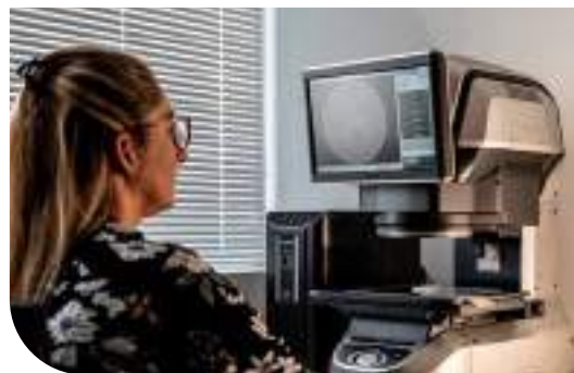
Contrôle projecteur de profil Keyence
