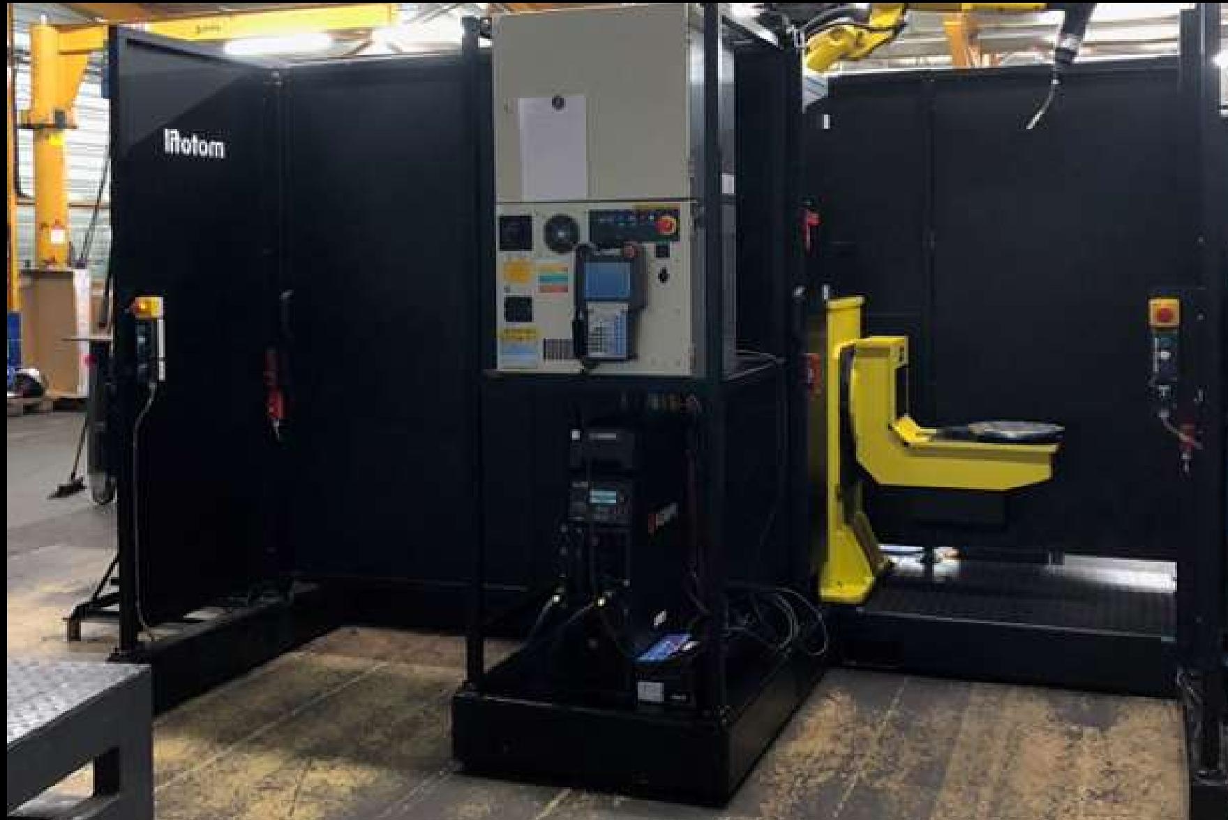
Robot de soudure FANUC (10 axes) Avec 2 positionneurs 2 axes
