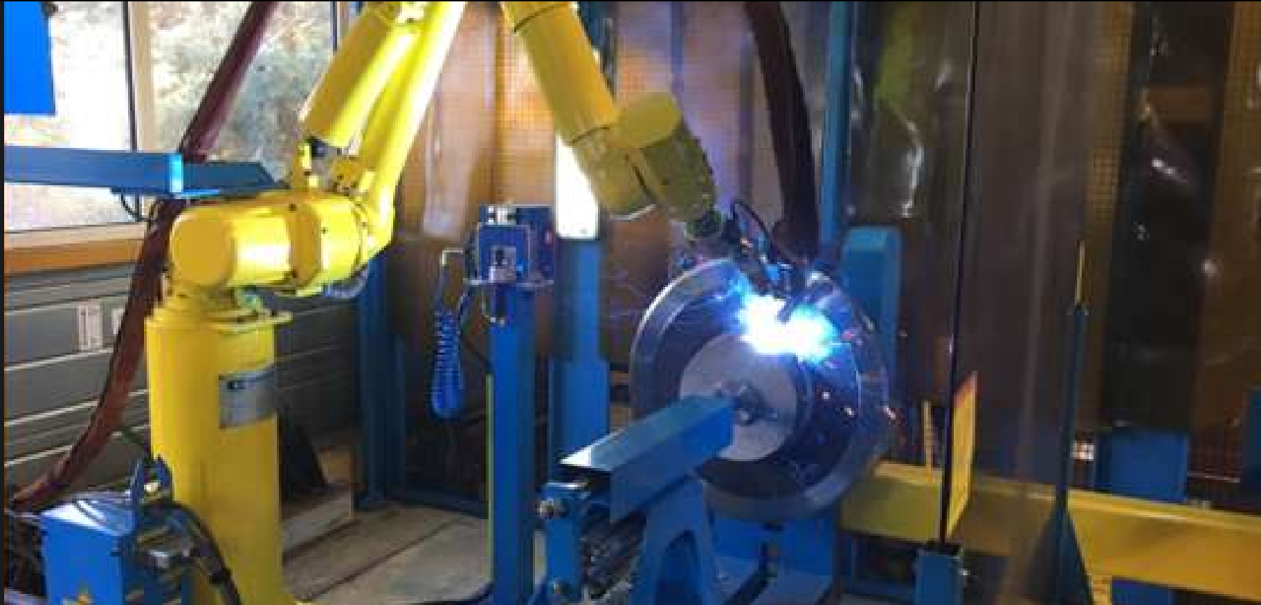
Axe 7 avec vireur inclinable pour souder en position
