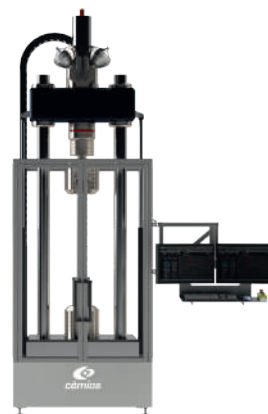
Traction/compression en chambre climatique
