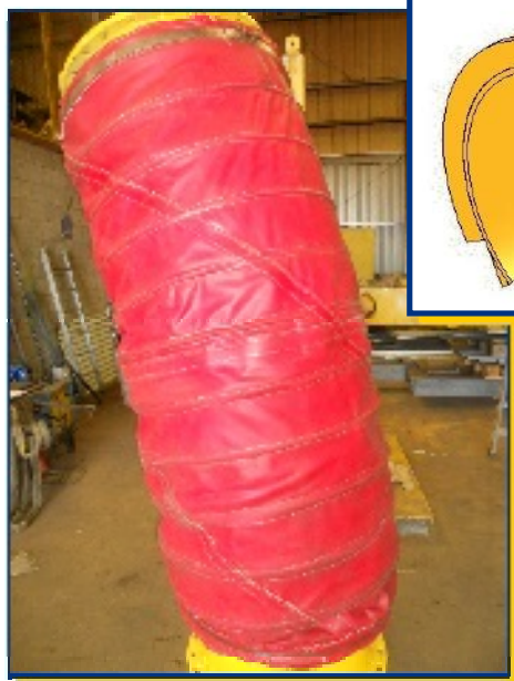
Compensateur dans installation de déchargement avec support et protection interne par un déflecteur flexible en métal
