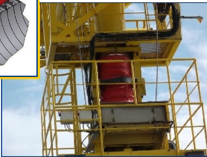
Compensateur dans installation de déchargement avec support et protection interne par un déflecteur flexible en métal
