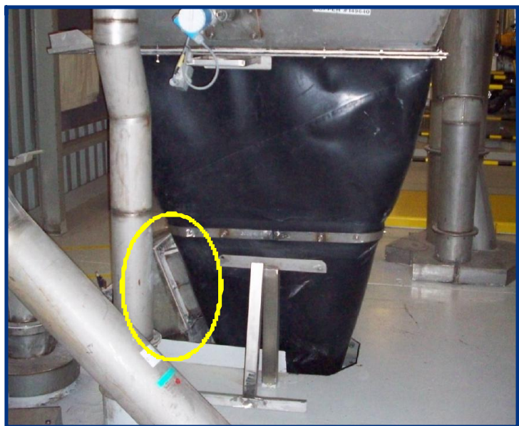
Compensateur caoutchouc avec prise d'échantillon intégrée sur le côté
