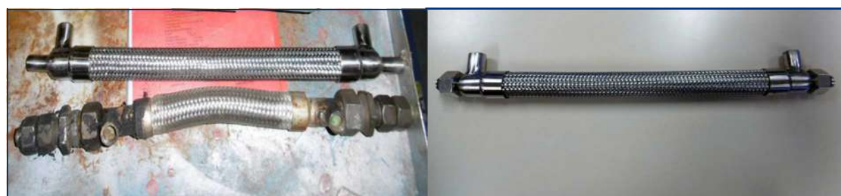
Un flexible à double enveloppe fabriqué sur mesures, suivant modèle.
