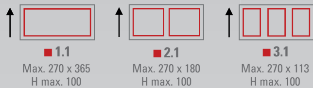
■ Formats et disposition des barquettes pour ReeBasic
