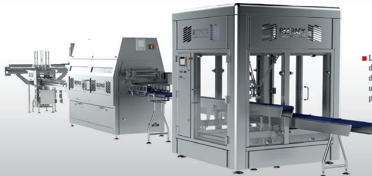
■ Ligne composée d'une operculeuse intégrant une dépose de couvercle
