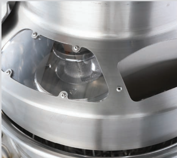
■ Protection en acier inox avec fenêtres en plexiglass pour vérifier le produit
