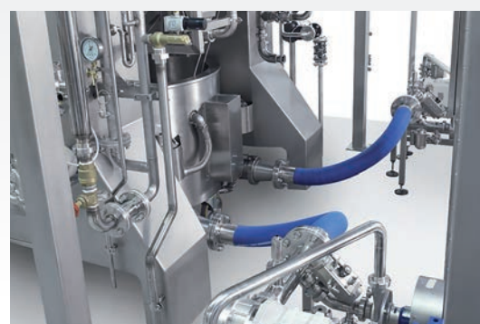
■ Vidange automatique par pompe de transfert embarquée ou au sol
