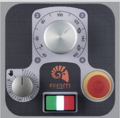
■ Réglage de vitesse par potentiomètre et minuteur
