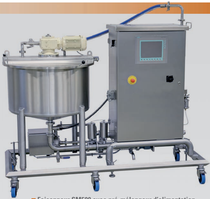
■ Foisonneur SM500 avec pré-mélangeur d'alimentation
