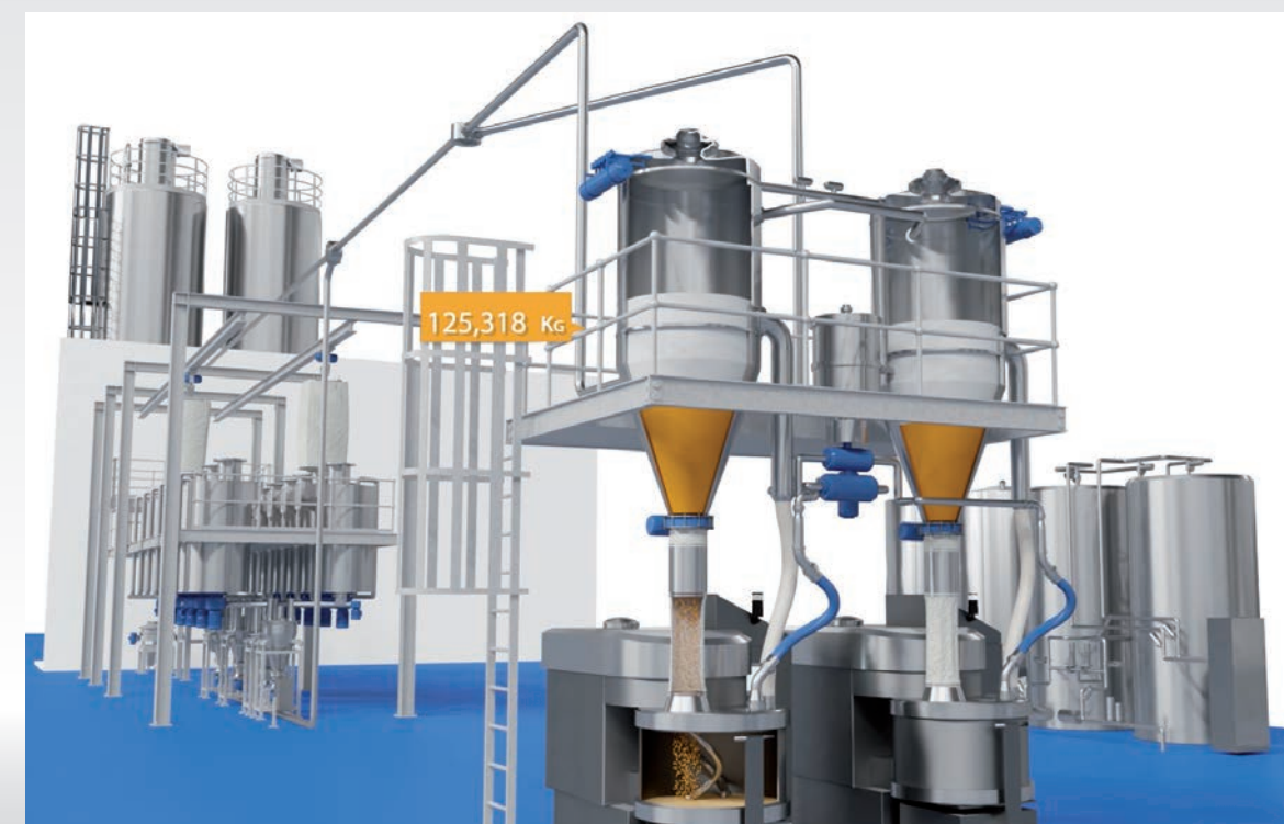
■ Plan du cheminement de la farine jusqu'au pétrin
