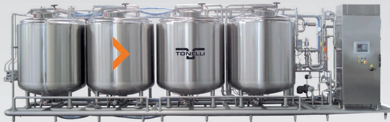
Nettoyage en place
