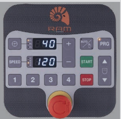
■ Réglage digital de la vitesse et stockage de 100 recettes
