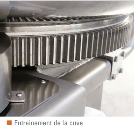
■ Entrainement de la cuve
