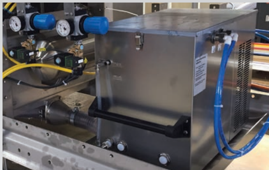
■ Refroidissement en circuit fermé
