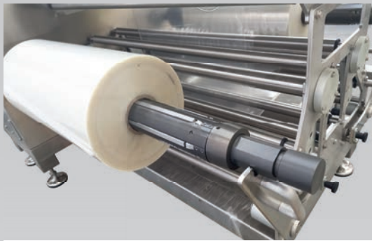
■ Porte bobine inférieur avec Servomoteur
