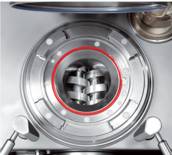
Double vis en place (trémie relevée)
