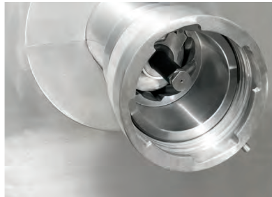
■ Remplacement du bâti de vis (vue extérieure)
