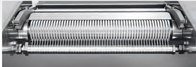
■ Rouleau entraîneur à stries longitudinales et transversales + peigne
