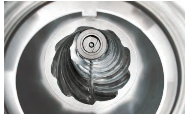
■ Remplacement du bâti de vis (vue intérieure)
