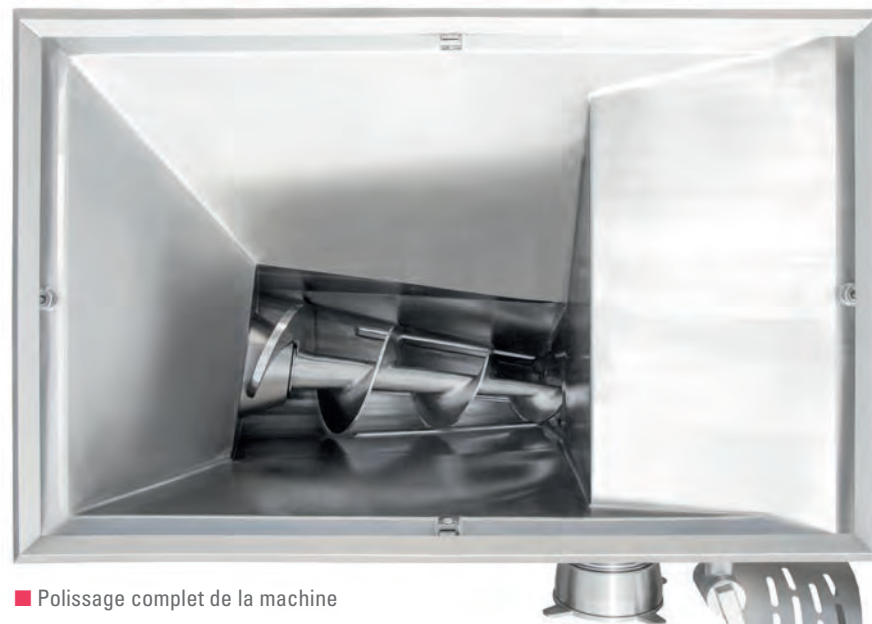
■ Remplacement du bâti de vis (vue intérieure)
