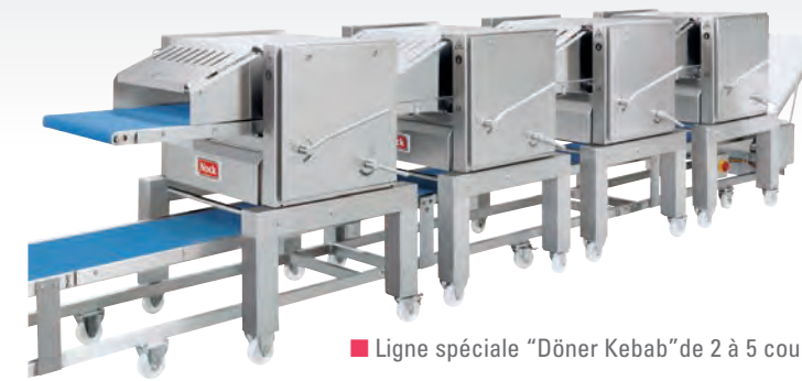
■ Convoyeur modulaire (option sur la CB 619)
