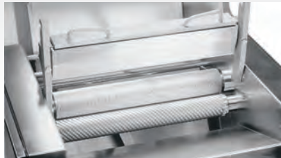
■ Rouleau entraîneur à stries longitudinales uniquement (+ rouleau de nettoyage)
