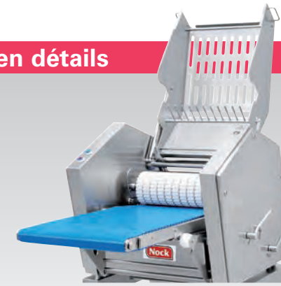
■ Convoyeur modulaire (option sur la CB 619)
