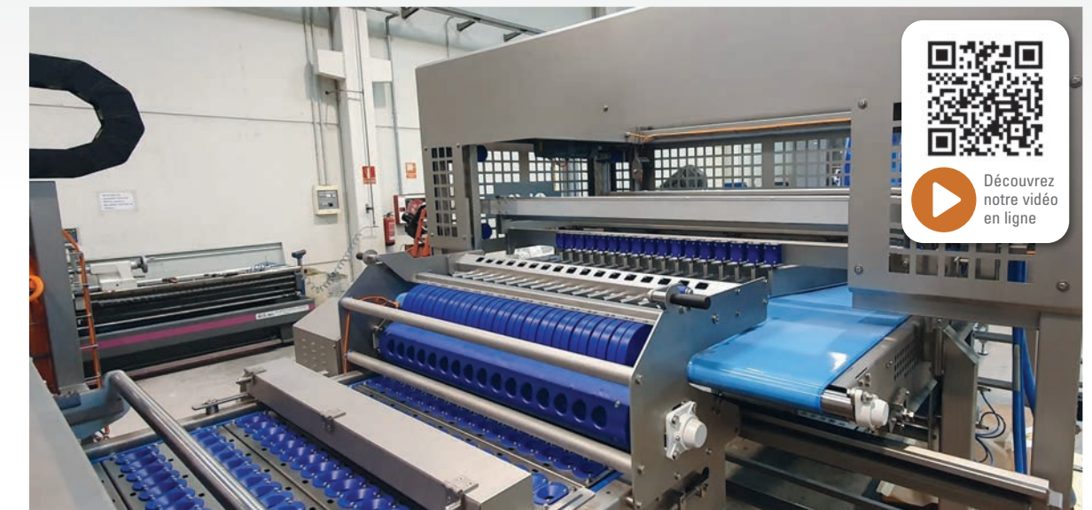
■ Injecteur volumétrique vertical pour produits frits (beignets, Berliner, Long John) Jusqu'à 40 cycles/minute par tête d'injection (selon l'application) et entre 5 000 et 100 000 coups/seconde
