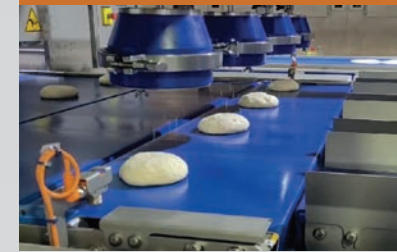
■ Microdosage d'huile (pizza, pinsa, focaccia, pain) Dosage entre 500 et 24 000 pizzas/heure selon la configuration de la ligne de production
