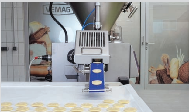
■ Diviseuse de pâtes HP1 + table de remplissage FT722 Applications dosage de pâtes liquides
