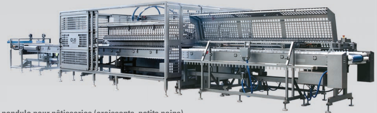
■ Injecteur volumétrique horizontal à pendule pour pâtisseries (croissants, petits pains) Jusqu'à 40 pistons volumétriques par tête d'injection, 50 000 coups/seconde et 20 000 produits/heure
