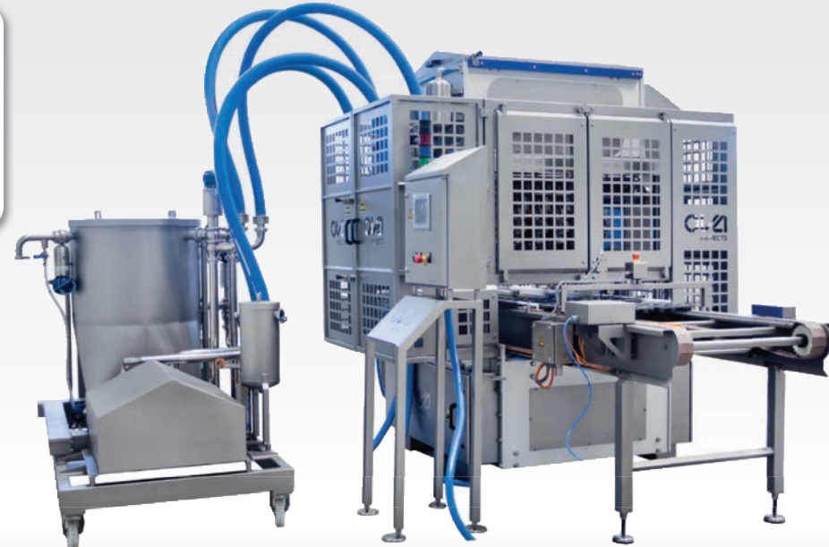
■ Doseur pour muffins et gâteaux sur plateau (muffins, cupcakes, gâteaux, brownies) Jusqu'à 60 pistons volumétriques par tête d'injection et de 1 000 à 50 000 coups/seconde
