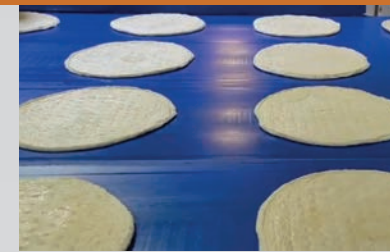
■ Microdosage d'huile (pizza, pinsa, focaccia, pain) Dosage entre 500 et 24 000 pizzas/heure selon la configuration de la ligne de production
