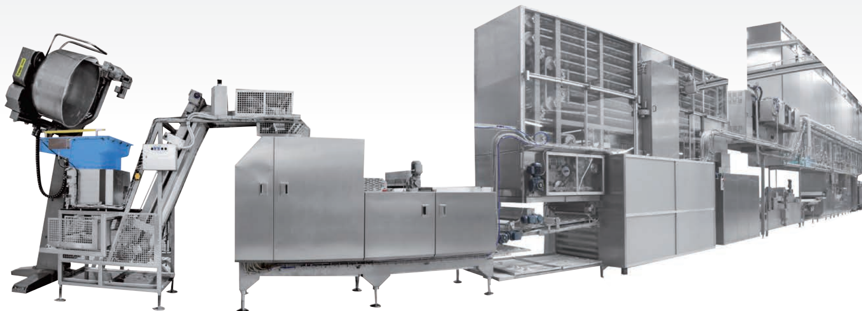
■ I-REX III Installation 10 rangées avec étuve de fermentation finale 30 000 pièces/h (Pains KAISER)
