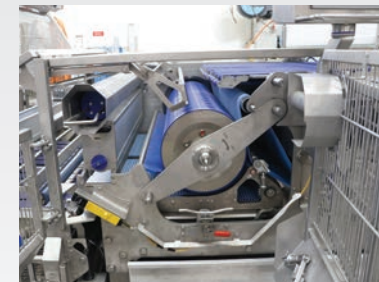
■ Accès au tambour de boulage
