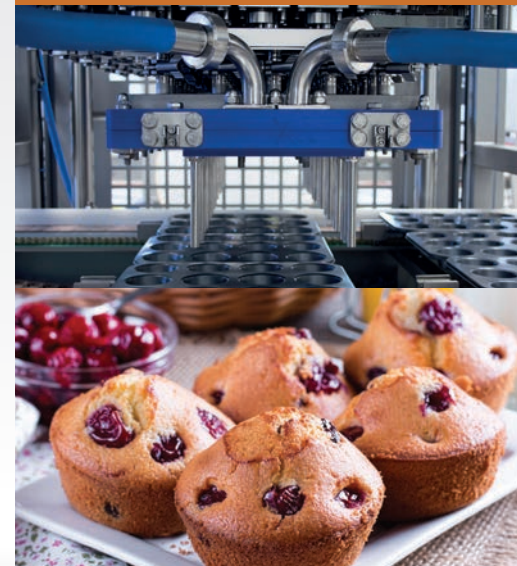
■ Doseur pour muffins et gâteaux sur plateau (muffins, cupcakes, gâteaux, brownies) Jusqu'à 60 pistons volumétriques par tête d'injection et de 1 000 à 50 000 coups/seconde
