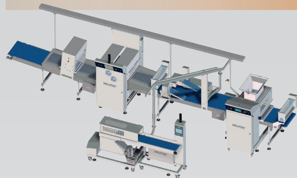
■ I-Block Line (de 200 à 1 000 kg de pâte par heure) Production de blocs de pâtes allant jusqu'à 7 couches
