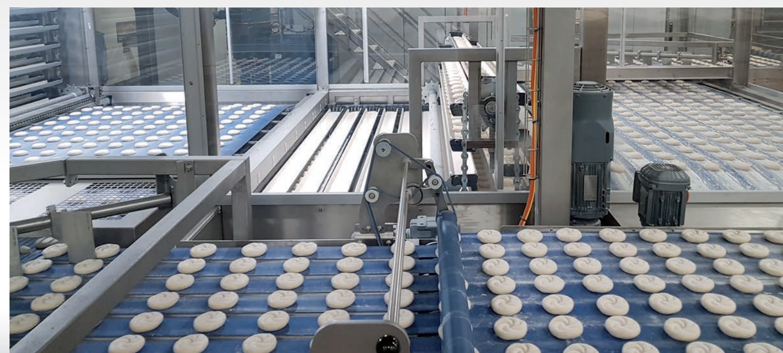
■ Chargement automatique balancelles de fermentation
