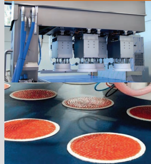
■ Doseur multipoints pour sauce tomate (pizza, pinsa, focaccia) Entre 500 et 24 000 pizzas/heure, en fonction de la configuration de la ligne de production
