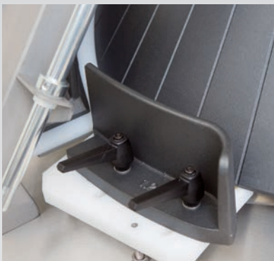
■ Rail d'entrée spécialement conçu, réglable manuellement
