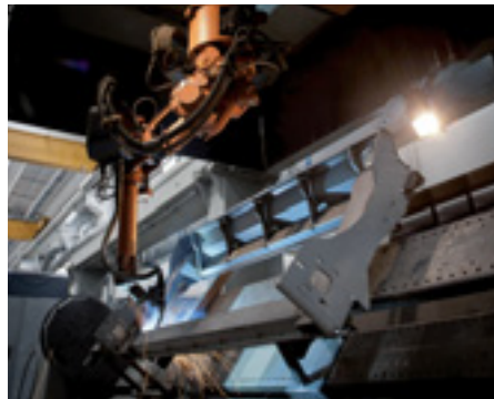
Quatre îlots de soudure robotisée
