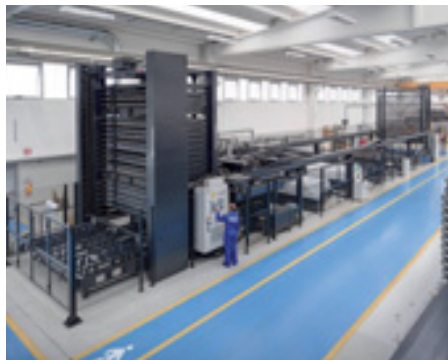
Installations de découpe laser robotisées
