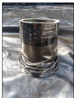
Soutirage ou remplissage par manchettes (passage sous la réserve ou sur le côté)
