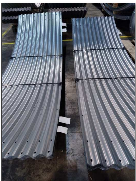
Tôles de réparation, de remplacement
