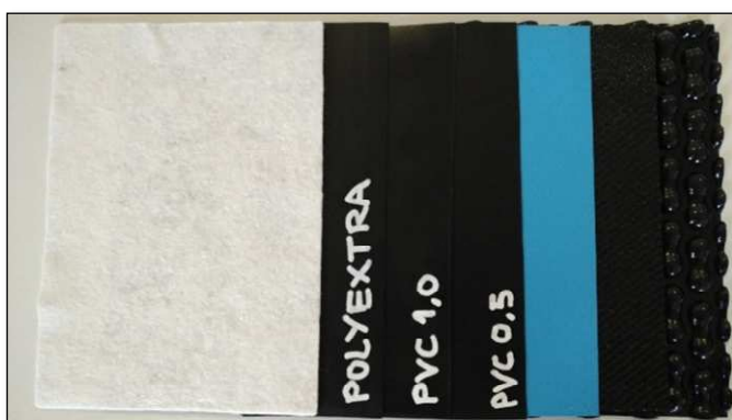
Liners possibles en Polychlorure de vinyle (PVC), Polypropylène (PP) ou Polyéthylène (PE)
