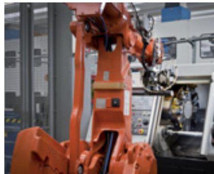
Neuf îlots de tournage robotisé
