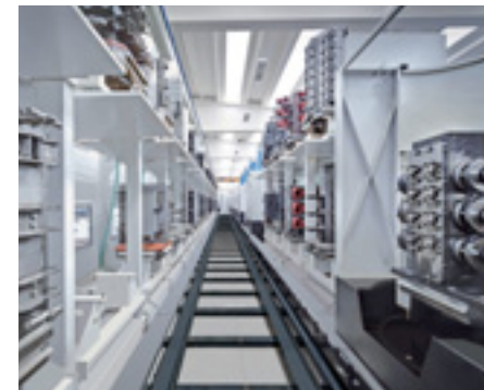
Centre de travail horizontal: production de boîtes de transmission et réducteurs
