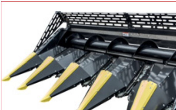
Grille de protection antichute latérale et postérieure
