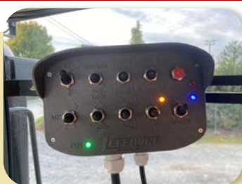
Commandes LS de toutes les fonctions + commandes latérales manuelles
