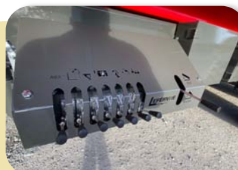
Commandes LS de toutes les fonctions + commandes latérales manuelles
