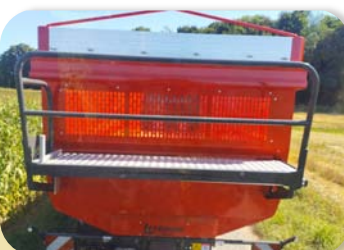
Passerelle sur toute la largeur de la caisse.
