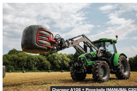
Chargeur A106 + Pince-balle (MANUBAL C30)
