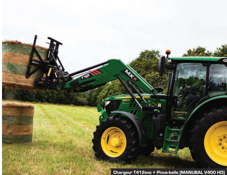
Chargeur T412evo + Pince-balle (MANUBAL V400 HD)
