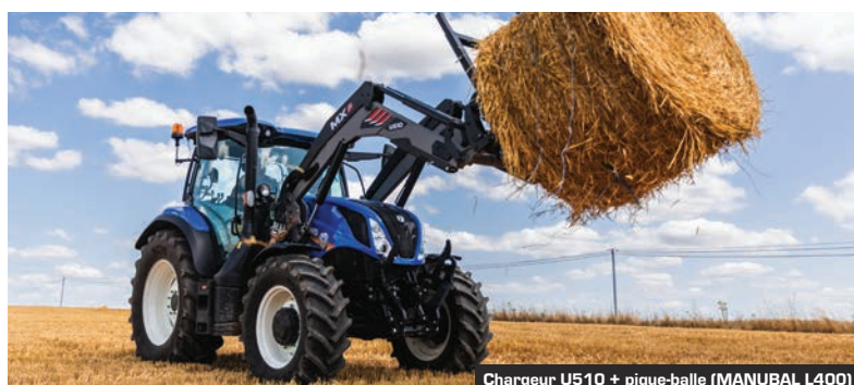
Chargeur U510 + pique-balle (MANUBAL L400)
