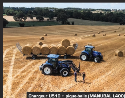
Chargeur U510 + pique-balle (MANUBAL L400)
