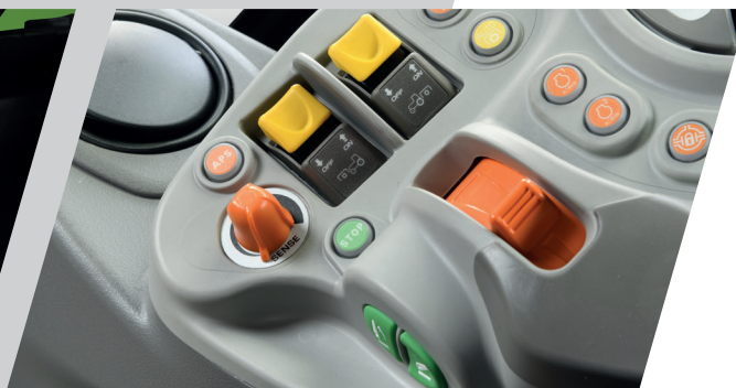
> PDF avant et arrière à engagement électrohydraulique et fonction Auto PDF.
