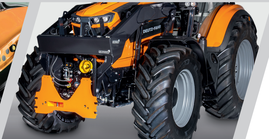
> Châssis porteur Sauter avec palette municipale réglable (catégorie 3/5) et support d'essieu pour charges d'attelage lourdes et stabilisateurs.
