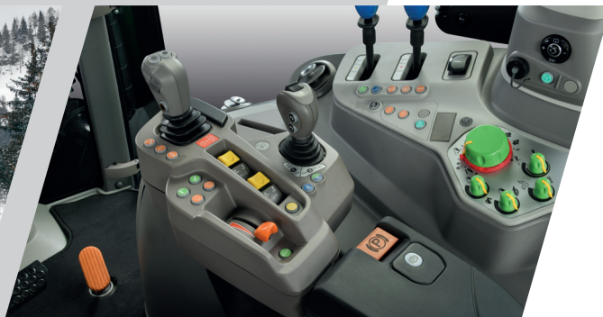
> Cabine MaxiVision* avec commandes des distributeurs arrières mixtes et gestion du chargeur électronique.
