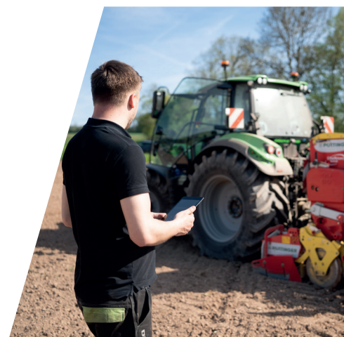
> Fonction XTEND avec tablette, contrôle des outils via ISOBUS UT tout en étant hors de la cabine.
