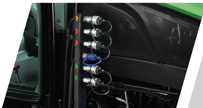
> Raccords hydrauliques montés au centre pour les outils avant.
