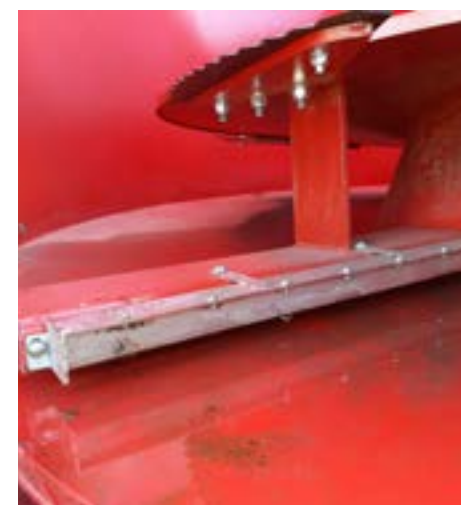
Aimant sur 2 ème pale sur vis de mélange
