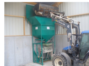
Alimentation en continu pour aplatisseur capacité 3,5 m 3 avec couvercle à vérins et estrade hte 1750 mm
