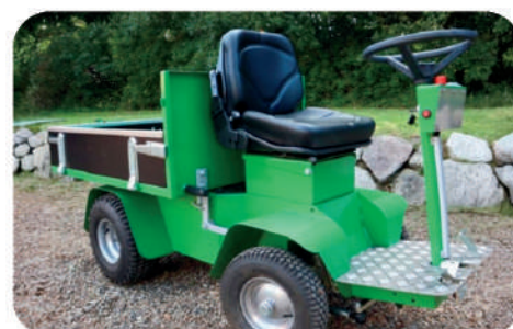
Transporteur électrique N330 Charge utile 330kg - Benne manuelle
