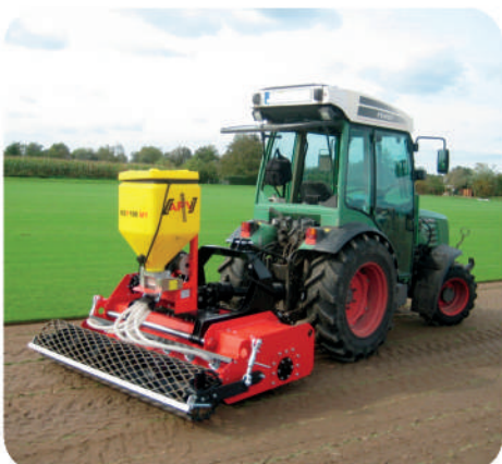
Enfouisseur pierres/Engazonneuse Agritec - Largeur de travail 120 - 140 - 160 ou 180cm
