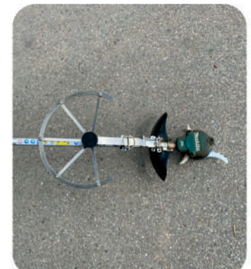
Arceau, déployé et replié, pour la protection des plantations - Accessoire pour débroussailluse
