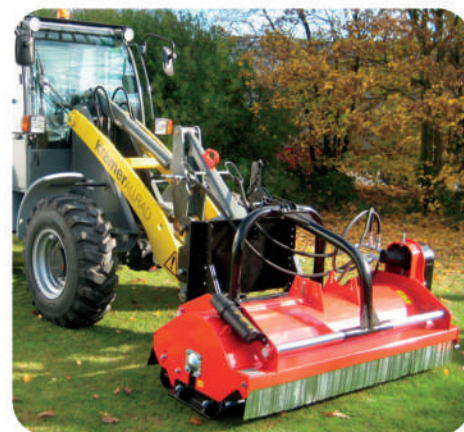
Broyeur à marteaux fléaux Agritec GS50 - Marteaux fléaux lourds 1200g
