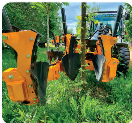
Arracheuse Motteuse Optimal Vario Transplantation de petits arbres en mottes Ø55cm max
