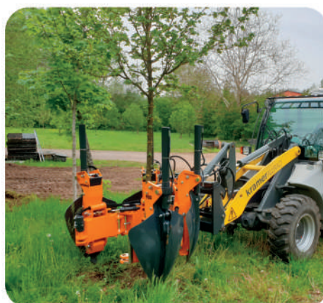
Arracheuse Motteuse Optimal 900 Transplantation de petits arbres en mottes Ø90cm max
