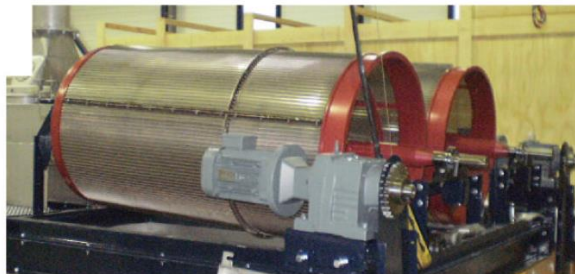
Cribles égoutteurs rotatifs Rotary screens
