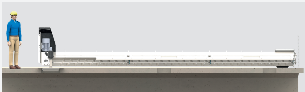
TYPE S 2 Le moteur électrique est à l'intérieur du silo, directement monté sur un réducteur entraînant la vis. L'alimentation électrique est assurée par un collecteur rotatif.
