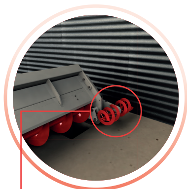
VIS DE DÉGAGEMENT Elle dégage la roue d'avance principale des impuretés concentrées en périphérie du silo. (incluse pour les grands diamètres de silos et pour certains produits).
