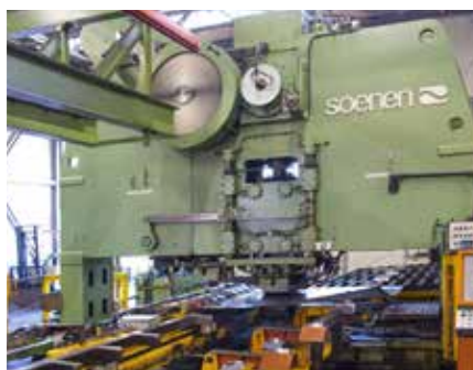
Grandes presses pour tôles jusqu'à 6000 x 2500 mm
