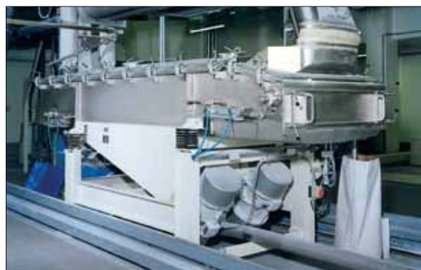
Photo 9 : Appareil de criblage vibrant SR 36/10 dans une usine agroalimentaire
