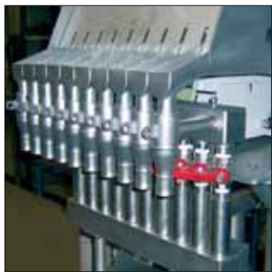
Photo 11 Configuration spéciale d'un convoyeur ER pour le dosage de granulés pour catalyseurs
