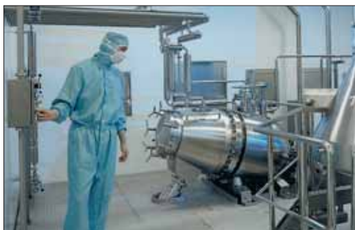
Photo 8 Appareil de criblage répondant à des exigences sanitaires strictes, satisfaisant au nettoyage en place (CIP), stérilisable (photo d'usine Schering AG)
