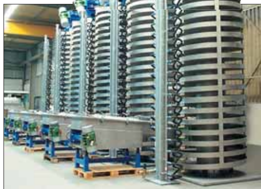
Photo 26 Convoyeurs vibrants hélicoïdaux de 1 400 mm de diamètre combinés à des appareils de criblage vibrants en amont pour le calibrage, puis le refroidissement de 3 000 kg/h de granulés en matière plastique
