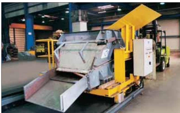
Photo 15 Chargement d'un four de fusion
