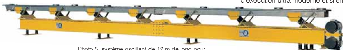
Photo 5 système oscillant de 12 m de long pour le transport de 10 t/h de lessive
