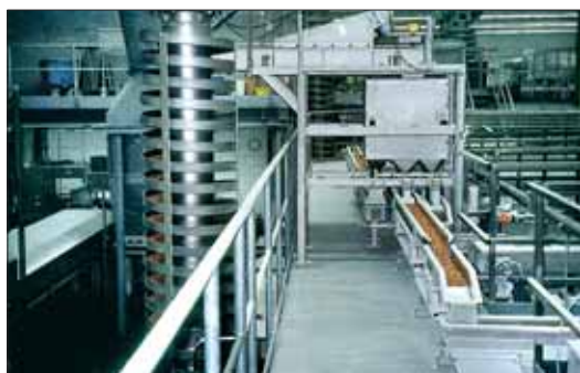
Photo 4 convoyeurs vibrants hélicoïdal et horizontal dans une usine agroalimentaire
