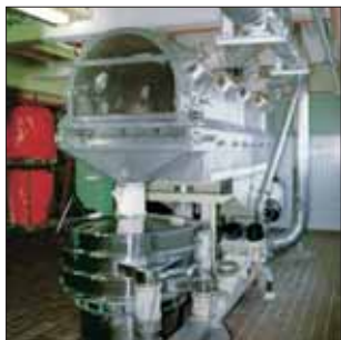
Photo 21 Séchoir à lit fluidisé vibrant VF 40/10 dans une usine agroalimentaire
