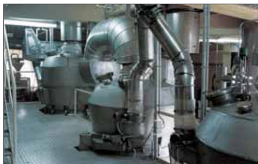
Photo 27 Séchoirs vibrants à lits fluidisés pour la torréfaction d'amandes et de noisettes en discontinu
