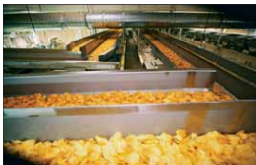
Photo 3 Vue partielle d'un système à résonance de 120 m de long pour le convoyage par vibration de 60 m³/h de chips de pommes de terre destinées à l'alimentation d'une ligne d'emballage
