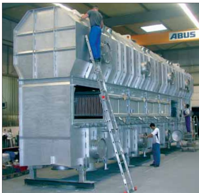
Photo 27 Séchoirs vibrants à lits fluidisés pour la torréfaction d'amandes et de noisettes en discontinu
