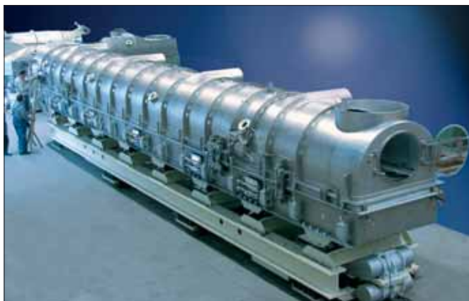
Photo 24 Système à résonance constitué d'un séchoir oscillant VR 160/15 avec une surface de fluidisation de 22m²
