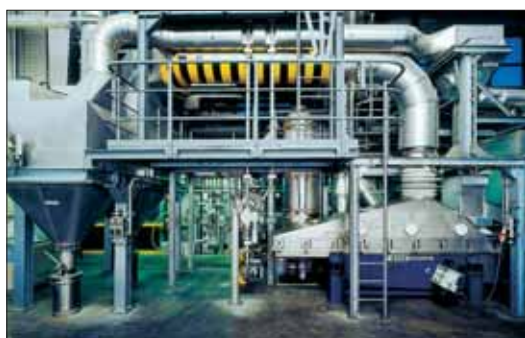
Photo 24 Système à résonance constitué d'un séchoir oscillant VR 160/15 avec une surface de fluidisation de 22m²
