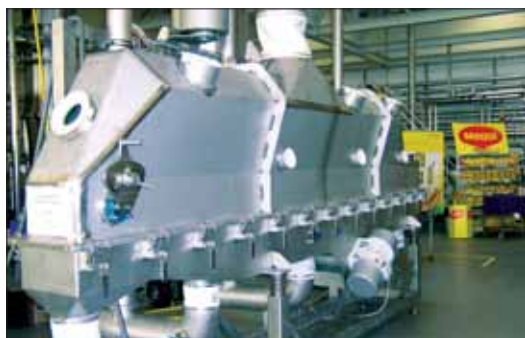
Photo 23 Séchoir à lit fluidisé vibrant VF 40/3,5 dans un « Product & Technology Center »
