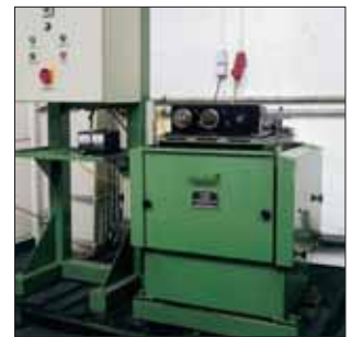
Photo 20 Table vibrante pour l'essai d'oscillation de boîtes de mesure électroniques
